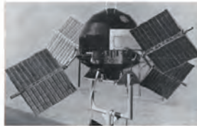
Satélite Explorer 6, con cuatro paneles PV compuestos por casi 10.000 células. [Fuente: https://en.wikipedia.org/wiki/Satellite ]
