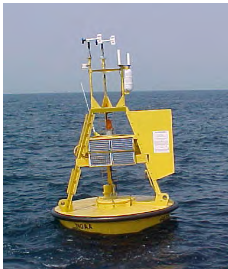
Boya marítima operada por la Administración Nacional Oceánica y Atmosférica de Estados Unidos [Fuente: https://commons.wikimedia.org/wiki/File:NOAA-NDBC-discus-buoy.jpg ]
