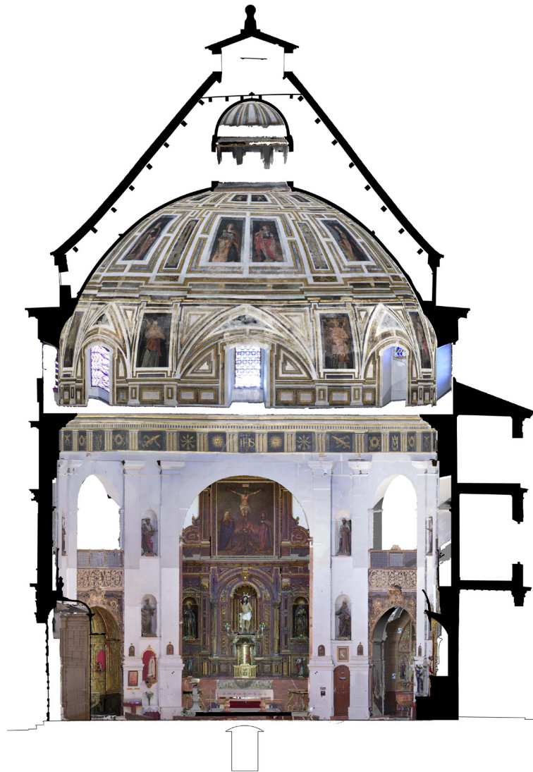
Sección Norte de la iglesia de San Sebastián (jesuitas). Ortofotografía del estado previo a la intervención. TCA Geomática. Fondo Gráfico IAPH.
